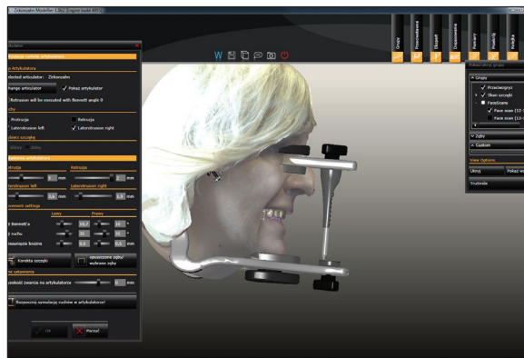
Ryc. 8. Wirtualny artykulator i skan twarzy pacjenta na ekranie komputera. (Materiał własny autorki)
