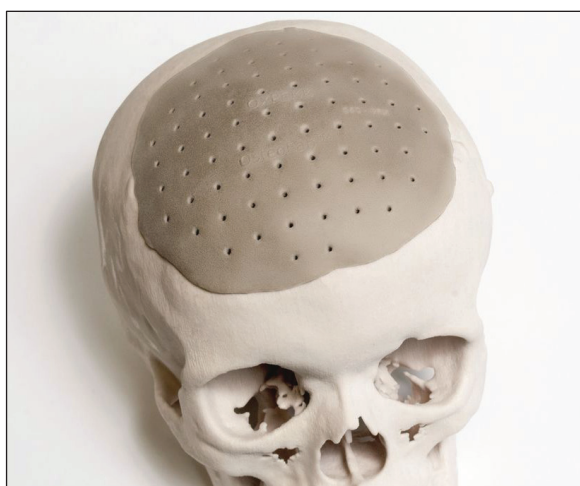
Ryc. 8. Biokompatybilny implant kości czaszki.
