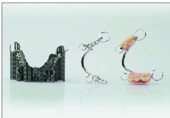
Ryc. 3. Proteza szkieletowa wydrukowana z wykorzystaniem techniki SLM.
