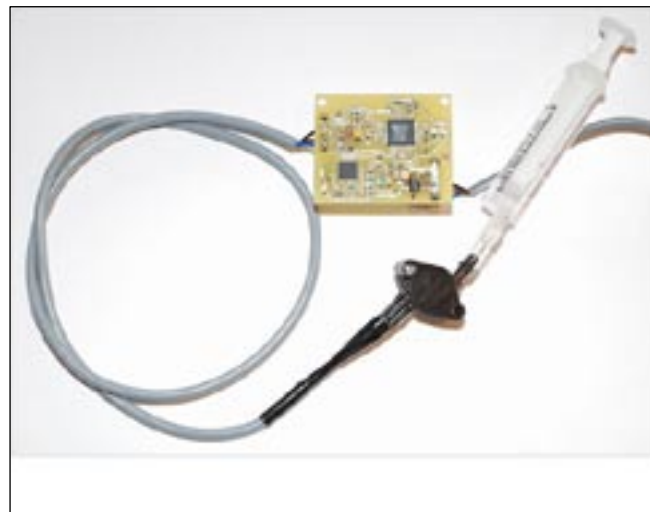
Ryc. 5. Elektroniczny układ odczytowy z mikro-mechanicznym czujnikiem ciśnienia MPX 5700DP.
