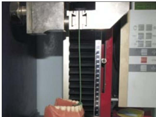
Ryc. 3. Stanowisko do badań fantomowych.
