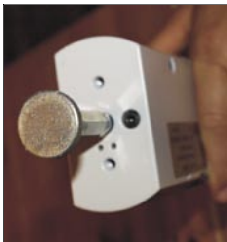
Ryc. 1. a – stolik siłomierza z naniesioną warstwą kremu adhezyjnego zmieszanego ze sztuczną śliną, b – wygląd stanowiska w trakcie przeprowadzania pomiaru.
