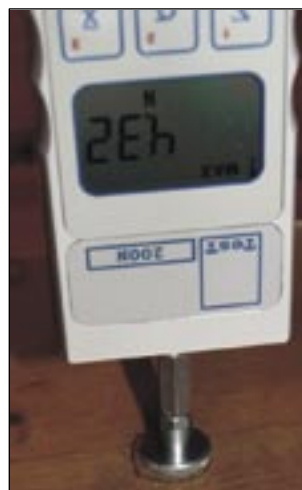
Ryc. 1. a – stolik siłomierza z naniesioną warstwą kremu adhezyjnego zmieszanego ze sztuczną śliną, b – wygląd stanowiska w trakcie przeprowadzania pomiaru.
